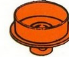
ROUES A BOUDIN 20 - Diam. 28 mm 20b - Diam. 19 mm
